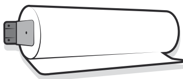
Halterung zur Wandbefestigung Fitting for wall mounting
